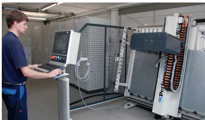
Das Perforex-Bearbeitungszentrum beschleunigt die Bearbeitung der Montageplatten bei der GWG Industrietechnik. Durch den automatischen Werkzeugwechsel kann das Bearbeitungszentrum bohren, fräsen und gewindeschneiden. Bilder: Rittal
