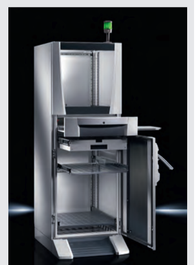
Der PC-Schrank verfügt über einen automatischen Potenzialausgleich des Schrankkorpus mit Rückwand und Bodenblechen. Die komplette Rechenausstattung mit Monitor, Rechner, Drucker, Tastatur und Maus lässt sich sicher unterbringen. Bild: Rittal
